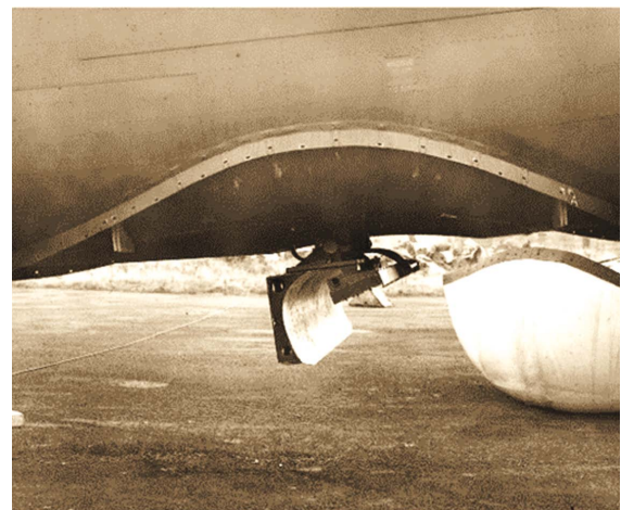
Рис. 4. Установка и использование самолетных радиолокаторов: а – диаграмма косекансного типа, б – пример установки на фюзеляже самолета
