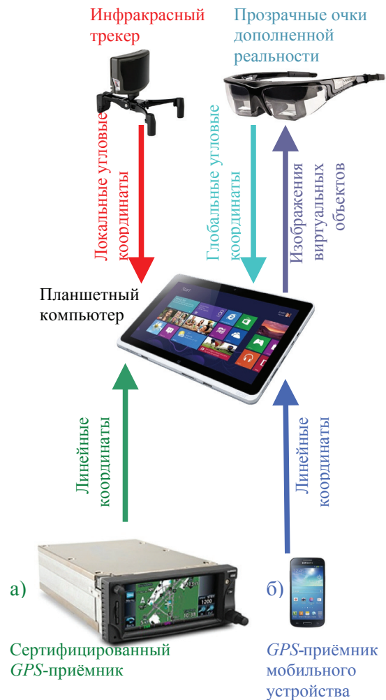
Рис. 3. Технические средства МСДР (конвертеры, контроллеры и адаптеры, используемые для связи компонентов, на рисунке не показаны): а) вариант с использованием сертифицированного GPS -приёмника; б) вариант с GPS -приёмником мобильного устройства
