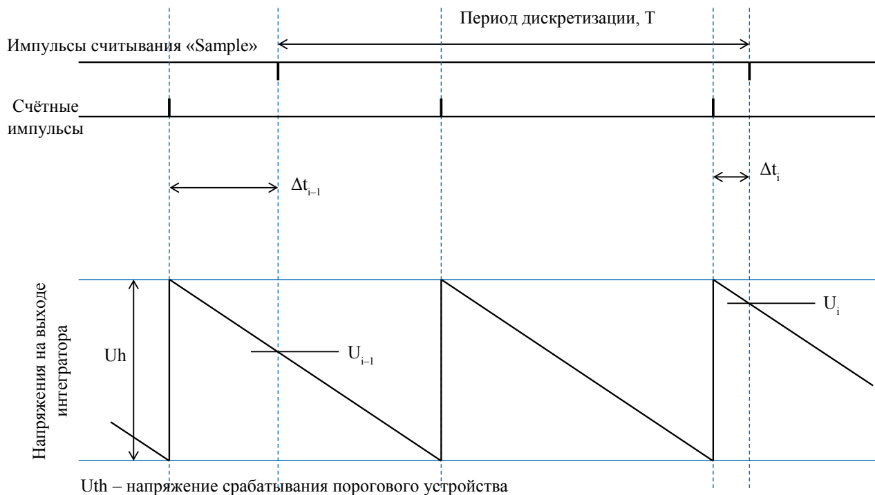
Рис. 2. Осциллограммы напряжения на выходе интегратора ПНЧ
