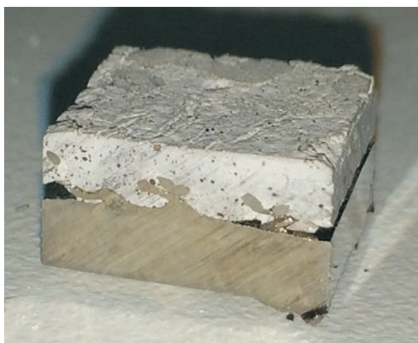
Рис. 4. Армированная подложка из нержавеющей стали 12Х18Н10Т: а – перед нанесением покрытия; б – после нанесения покрытия
