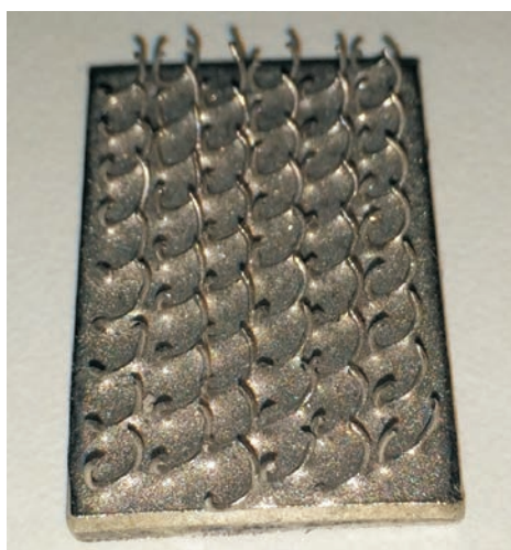
Рис. 3. Схема крепления армирующих элементов к металлической подложке: 1 – места пайки; 2 – армирующие элементы; 3 – подложка
